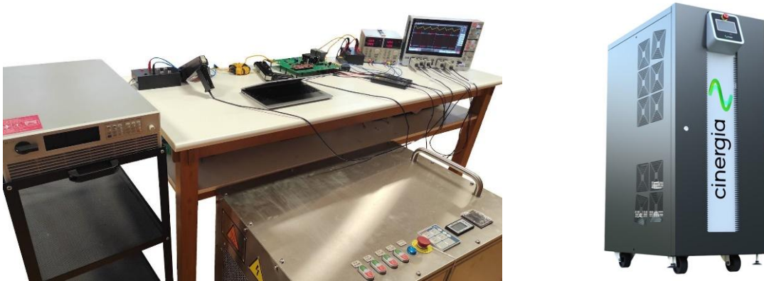
Şekil 7. Powering Yüksek Güç Laboratuvarı (1800V, 30A Güç DC Güç Kaynağı, 30 kVA 400V Şebeke Simülatörü, Osiloskop, Ölçüm Problemleri)
